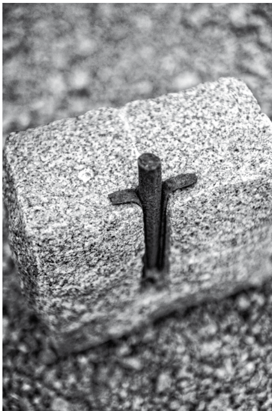
Rundkil med kilbläck som bröt isär stenen med ett jämnt tryck när man slog på kilen med släggan.
